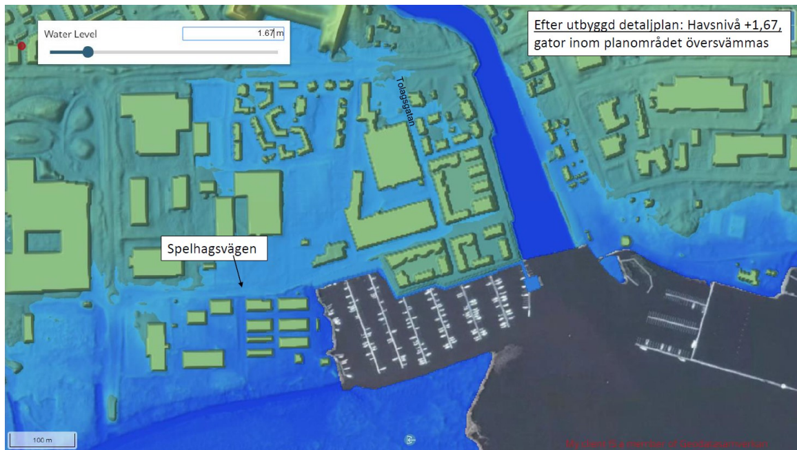
Figur 6-31. Översvämningssituation för förväntat vattenstånd år 2100 motsvarande återkomsttiden 100 år, med aktuellt planförslag. Situationen ger översvämning i stora delar av Spelhagen, som också går in bakvägen in i planområdet.
