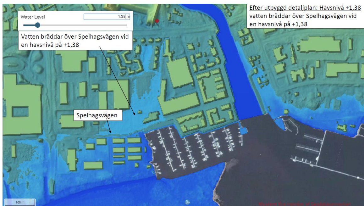
Figur 6-29. När vattenståndet stiger upp över + 1,37 m ger nya höjder på kajer för aktuell plan ett skydd. Spelhagsvägen översvämmas i en sådan situation i sin nuvarande höjd och översvämningen sprider sig in i Spelhagens centrala delar.
