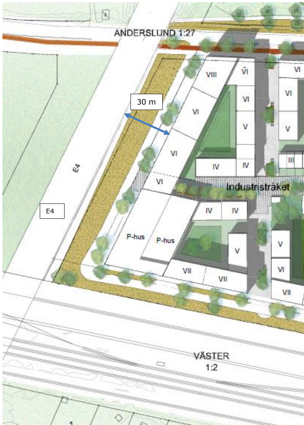
Figur 3 - Föreslagen situationsplan som visar byggnation längs E4:an. Avståndet är 30 meter mellan byggnader och E4:an. E4:an går på en bro 6 m över marken förbi planområdet och passerar även över järnvägen på bron. Se även plankarta enligt referens [12]. Sträckan där E4:an passerar planområdet är 150 m.
