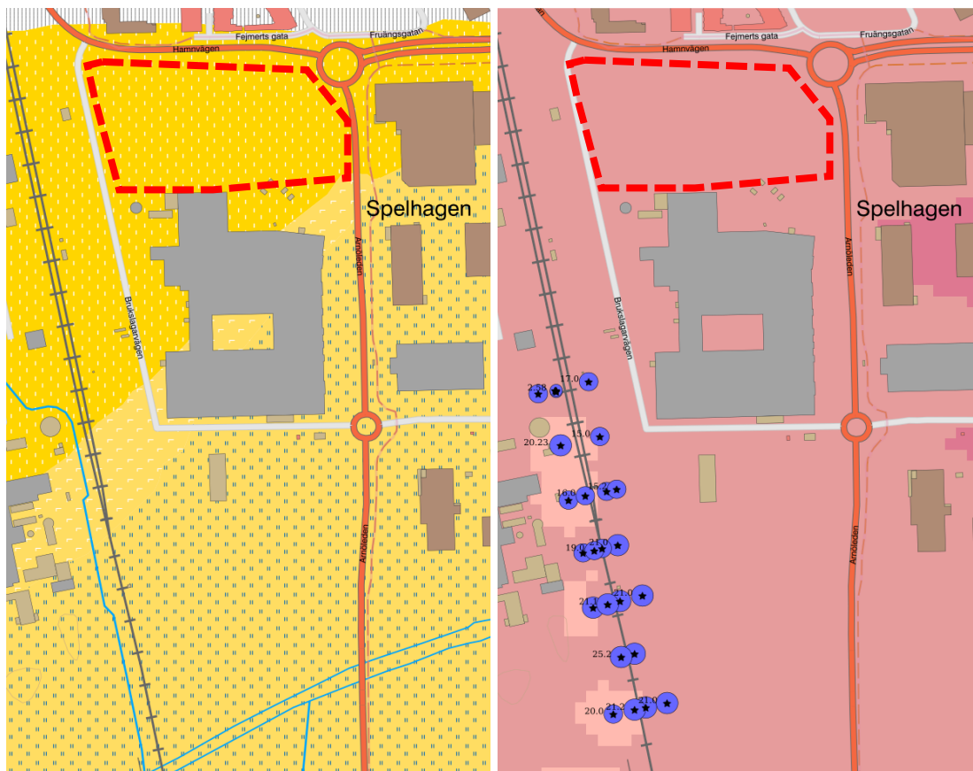
Figur 4. Jordartskartan (t.v.) och jorddjupskartan (t.h.) från Sveriges geologiska undersökning (SGU) över fastigheten Ribban 7 enligt rödstreckad markering. Jordartskartan visar att området till största del består av glacial silt (gult med vita lodräta streck). Jorddjupskartan inom Ribban 7 visar att det skattade jorddjupet uppgår till 20 – 30 m (mörkröd). Längs befintliga järnvägsspår finns utförda brunnborringar (blå cirkel med svart stjärna) med siffermarkering för uppmätt djup till berg. För fullständig teckenförklaring hänvisas till sgu.se.
