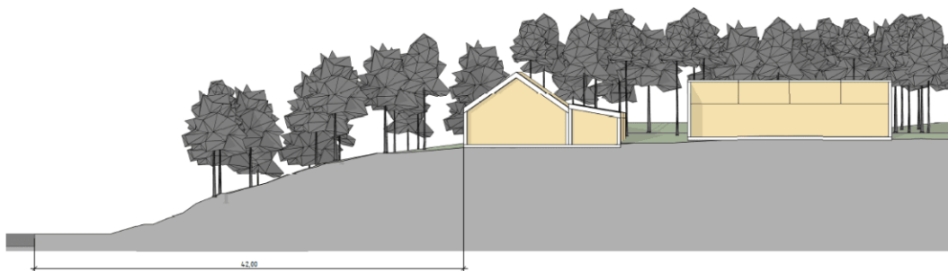
Figur 28. Sektion D-D. Inzoomad rendering som illustrerar nivåskillnaden mellan bebyggelsen och påfarten till E4.
