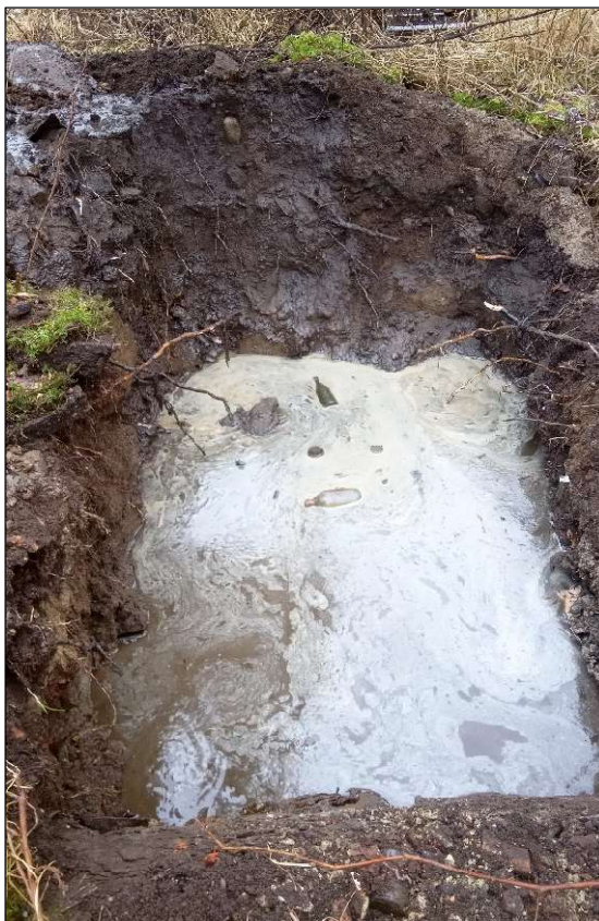
Provgrop 22TF12. Djup 1,2 meter, avfall i mättad zon.
