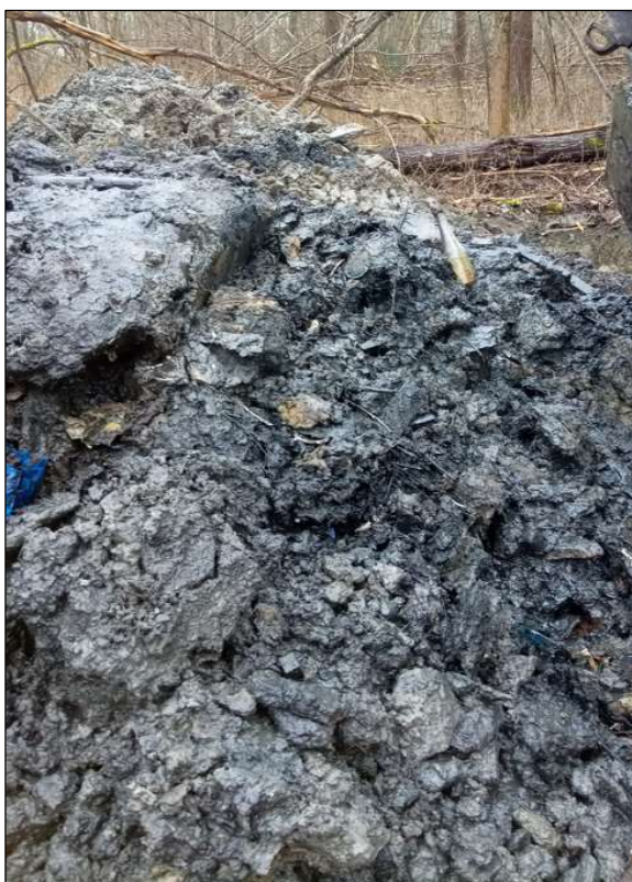
Provgrop 22TF10, närbild på vattenmättat avfall.
