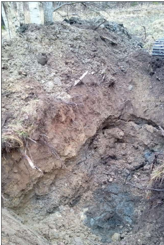
Provgrop 22TF11. Djup 1,8 meter, svart vatten ca 1, 2 meter under markytan. Sanden kan vara gjuterisand.
