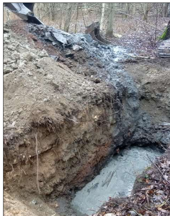
Provgrop 22TF08. Djup 2,1 meter. Avfall i mättad zon.
