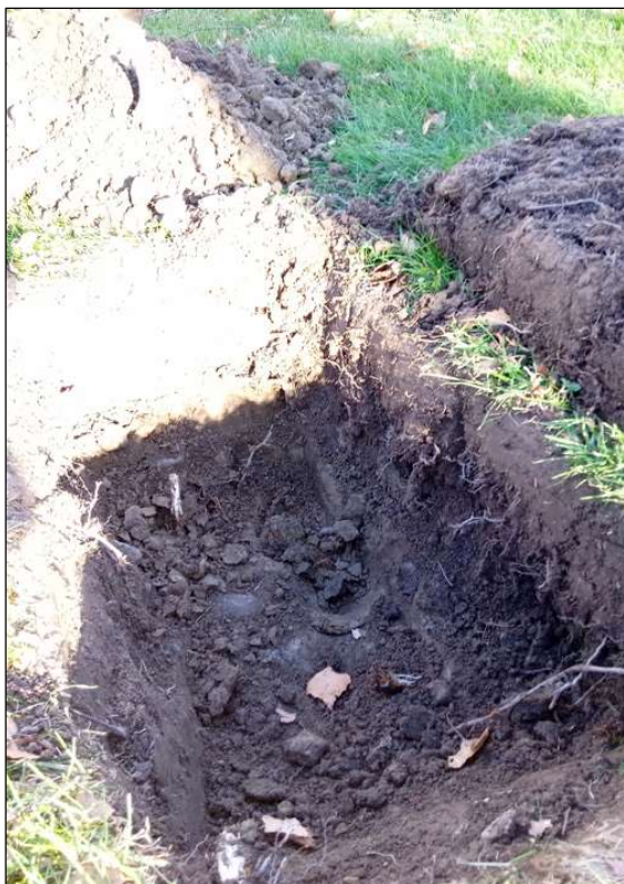
Provgrop PG5, handgrävning ner till 0,4 m.
