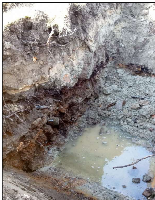
Provgrop 22TF03. Djup 1,6 meter, avfall syns i schaktväggen. Vatten påträffades 1,3 meter under markytan.
