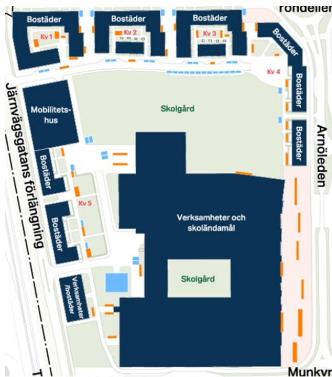
Figur 16. Placering av cykelparkering (orange) och parkering för personer med rörelsesnedsättning, hämta/lämna-platser till skolan samt verksamhetsparkering för bil (blå) utomhus. Källa: Urban Minds
