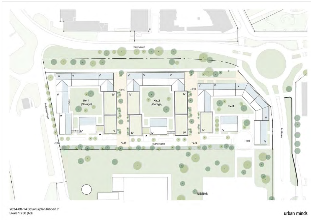
Strukturplan för Ribban 7 daterad 2024-08-14. Förslaget avser flerbostadshus i fyra till fem våningar med möjlighet till kommersiella lokaler i bottenvåningen.
