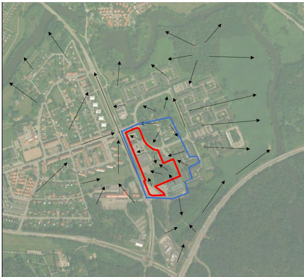
Figur 3 Avrinningsvägar inom området. Planområdet markerat med rött och planområdets topografiska avrinningsområde markerat med blått.
