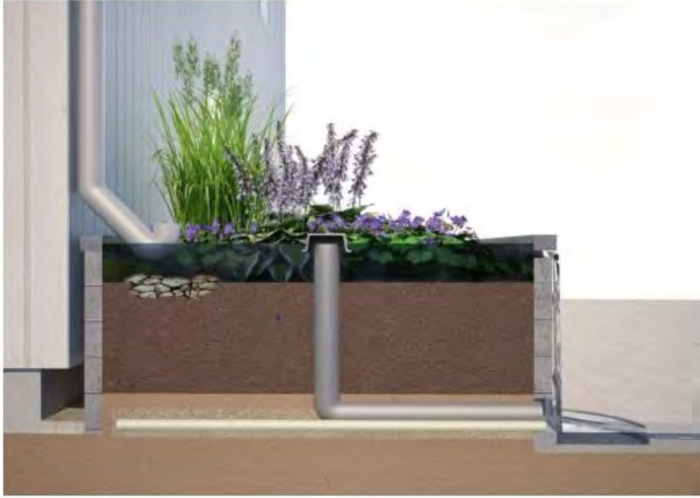
Figur 13 Biofilter med dräneringslager och dräneringsledning i botten utan tätskikt (Vinnova, 2014).
