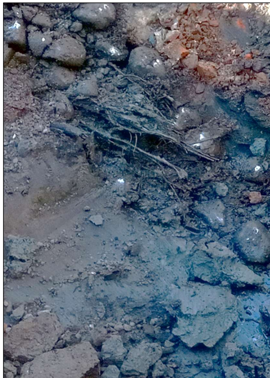
Provgrop TF13, ris i f.d. dräneringsdike.
