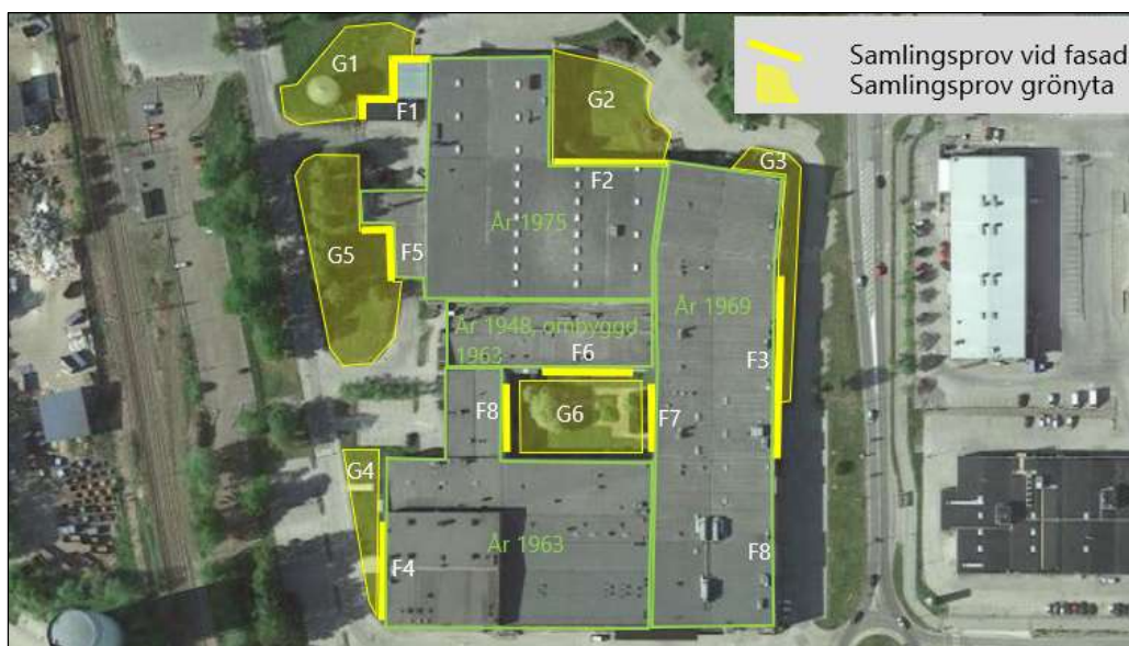
Figur 11. Mark vid fasad samt grönytor där PCB provtogs i ytjord.
