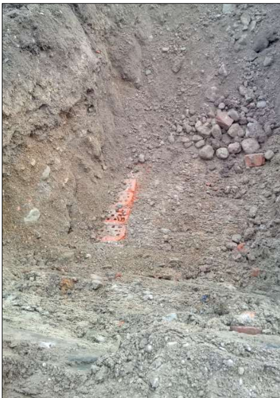
Provgrop TF24. Gammal ledningsgrav av tegel.
