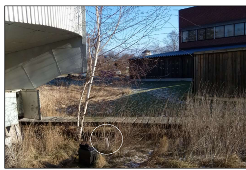
GV-rör vid cistern (XX03), inget lock. Rördjup 3,80 meter, gvy fr ök rör 1,15. Ej oljefilm på vatten, lukt av svavelväte.
