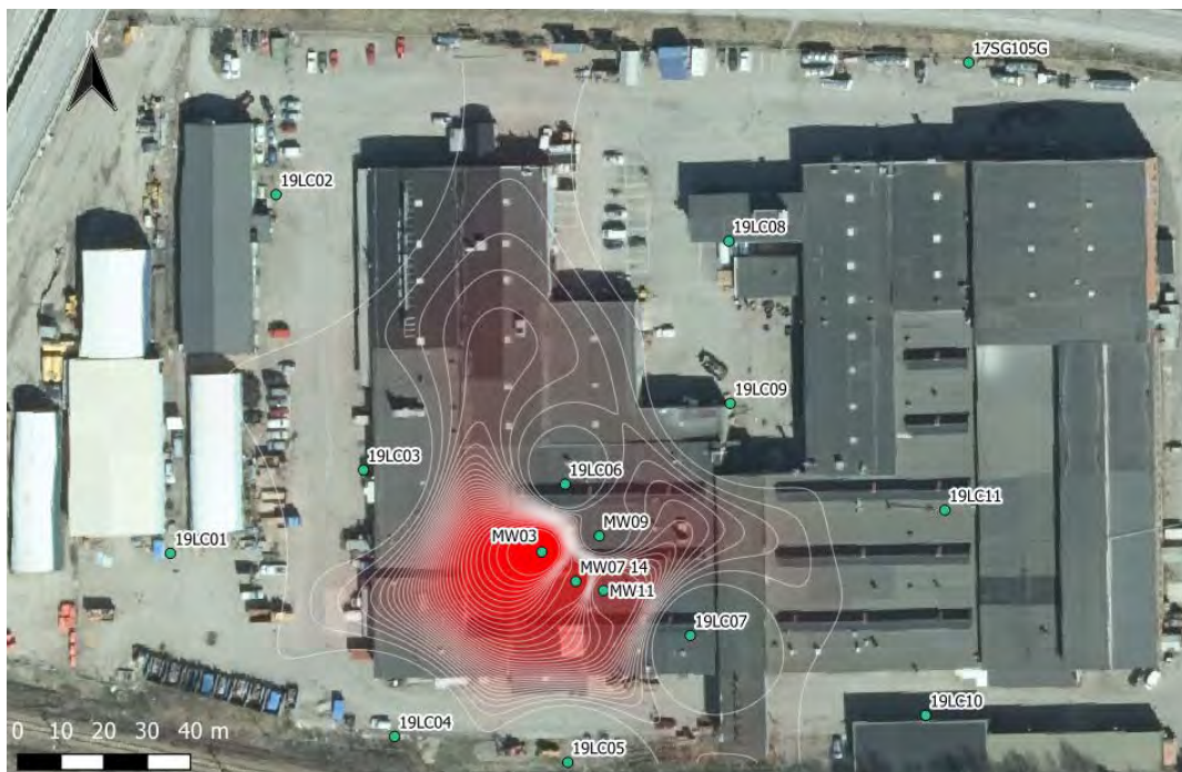
Figur 1 Interpolering av TCE-ekvivalenter i grundvatten baserat på prover tagna i de senaste två undersökningarna. Modell skapad i QGIS. Alla halter i \mu\text{g/l} . Interpoleringen bör endast ses som en fingervisning av föroreningsutbredning och inte som skarpa gränser. Högsta halter i rött, därefter avtagande mot färglöst, linjeavstånd ca 800 \mu\text{g/l} .
