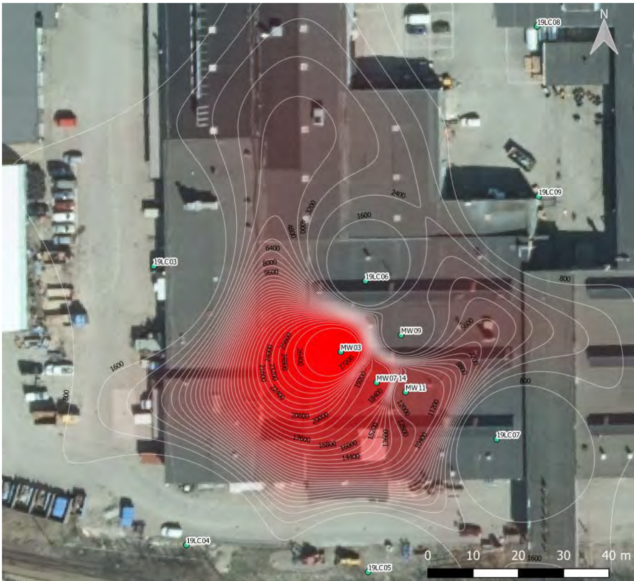
Figur 2. Inzoomning av interpolering av halter klorerade alifater på ca 12-14 m djup. Svarta siffror visar på interpolerade halter, haltavstånd mellan 2 linjer är 800 ug/l.
