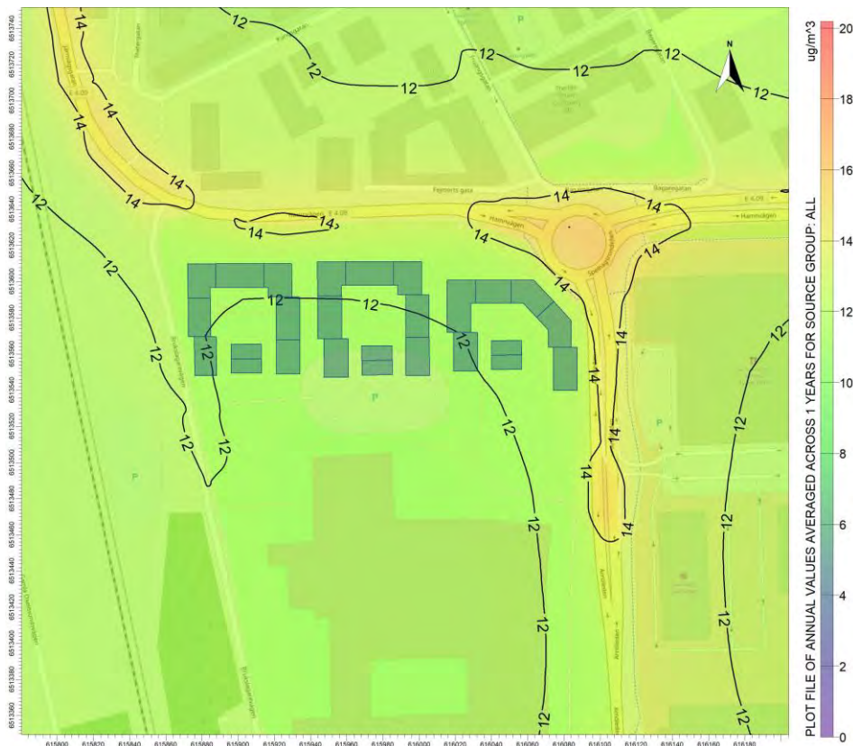
Figur 10. Framtida scenario 2040, beräknade halter av partiklar ( PM_{10} ) som årsmedelvärden. Planområdet markeras med lila linje.
