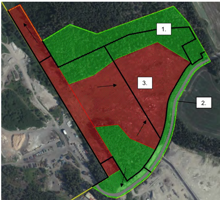
Figur 34. Ytkartering för befintliga förhållanden för det östra området (gröna ytor markerade med nummer ett är skog och blandat grönområde, gråa ytor markerade med nummer två är vägytor och röda ytor markerade med nummer tre är hygge och kraftledning). Pilar visar avledning och de tjocka svarta linjerna visar delområden.
