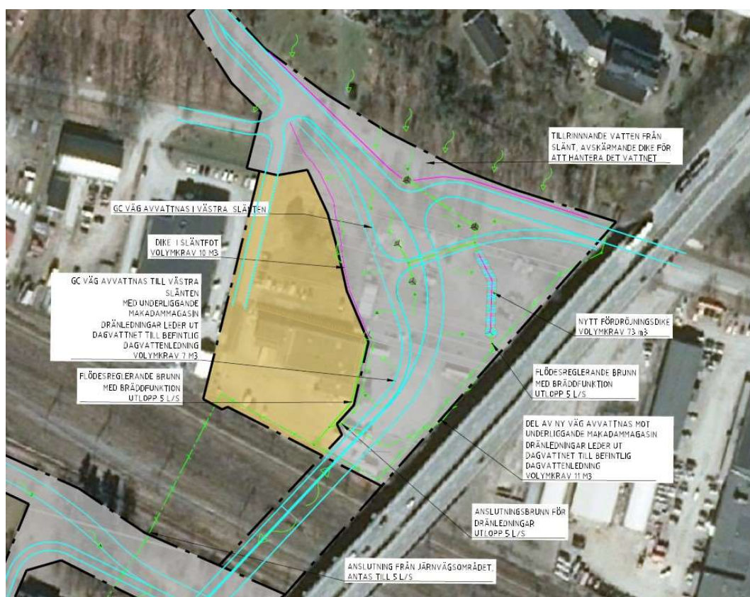
Figur 7: Utklipp från illustrationsplan över dagvattenhantering i norra delen av planområdet (SWECO, 2022).
