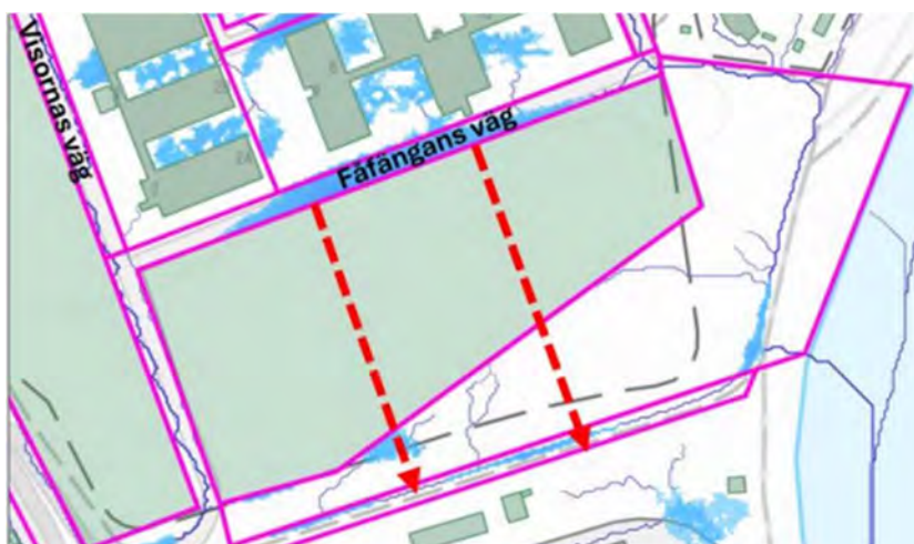
Figur 38 Exempel på släpppunkter för att leda skyfallsvatten genom planerat bostadskvarter för att avlasta potentiell lågpunkt på Fåfångans väg, Norconsult.
