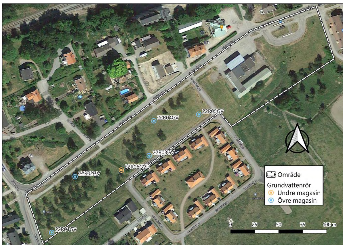
Figur 4. Placering av nyinstallerade grundvattenrör. Rör 22R01GV-22R05GV (blå) är installerade i det övre magasinet. Rör 22R06GVU (gul) är installerad i det undre magasinet. I 22R06GVU utfördes även en sondering. Bakgrundskarta från Google (Google, u.d.).
