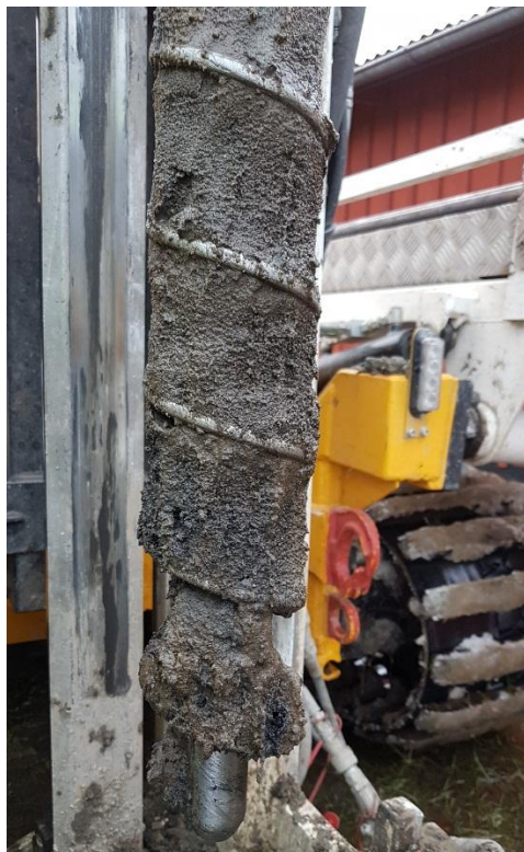
Figur 5. BP 17S116. Djup 0,7-1,0 m, sand, lukt av diesel
