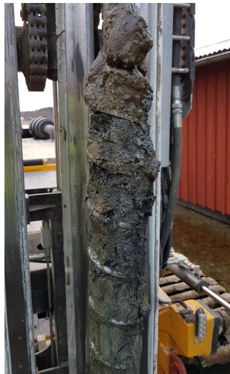
Figur 6. BP 17S116. Djup 1-1,5 m, övergången sand till lera, diesel i
