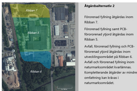
Åtgärder enligt Alternativ 2 i åtgärdsutredningen. Allt avfall samt fyllning med föroreningsnivåer över platsspecifika riktvärden åtgärdas inom Ribban 5 och 7 samt inom det planerade utvecklingsområdet inom Ribban 6. Avfall och förorenad fyllning inom naturmarksområdet på Ribban 6 kvarlämnas, eventuellt med kompletterande åtgärder.”
