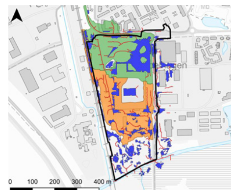
Översvämningsutbredning på grund av skyfall med befintliga marknivåer (blått). Rinnvägar och huvudsakliga avrinningsområden redovisas.
