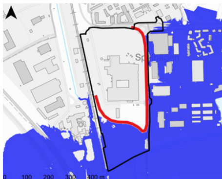
Översvämningsutbredning år 2125 vid ett 100-årshögvatten (+2.1 m) med åtgärd. Skyddet fungerar även för höga flöden i vattendrag.
