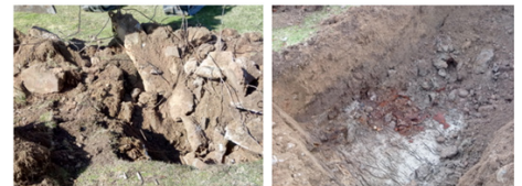
Fyllningsmassor med inslag av tegel och andra rivningsrester inom Ribban 5 och Ribban 7.
