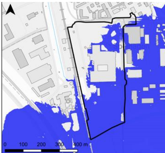
Figur 29. Översvämningsutbredning år 2125 vid ett 100-årshögsvatten (+2.1 m) med åtgärd. Skyddet fungerar även för höga flöden i vattendrag.
