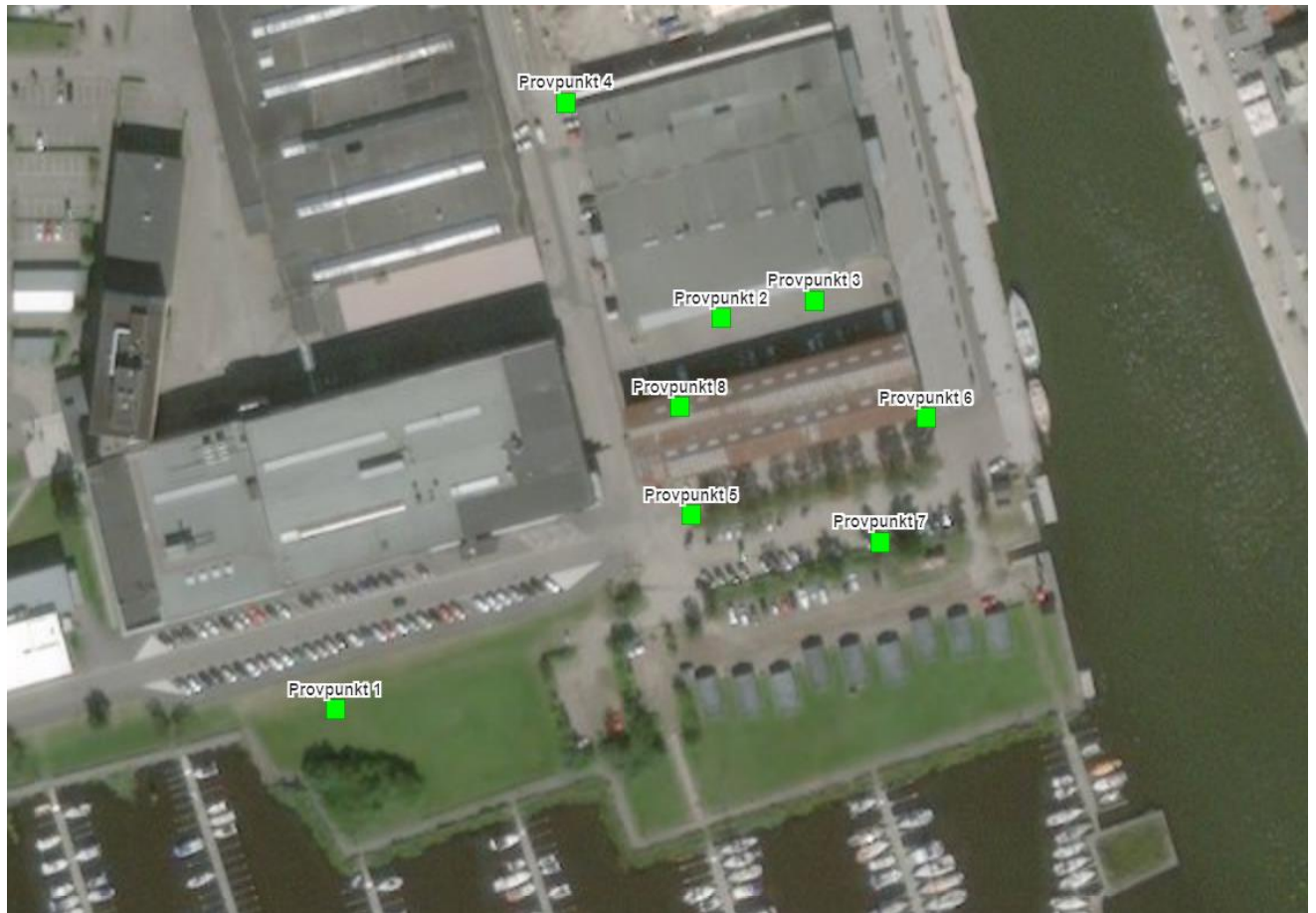
Figur 3. Karta med provpunkter. Mätning av metangas skedde i grundvattenrör (punkt 1 och 7), dagvattenbrunnar (punkt 2, 3, 4, 5 och 6) samt i spricka i golv inomhus i en industribyggnad (punkt 8).
