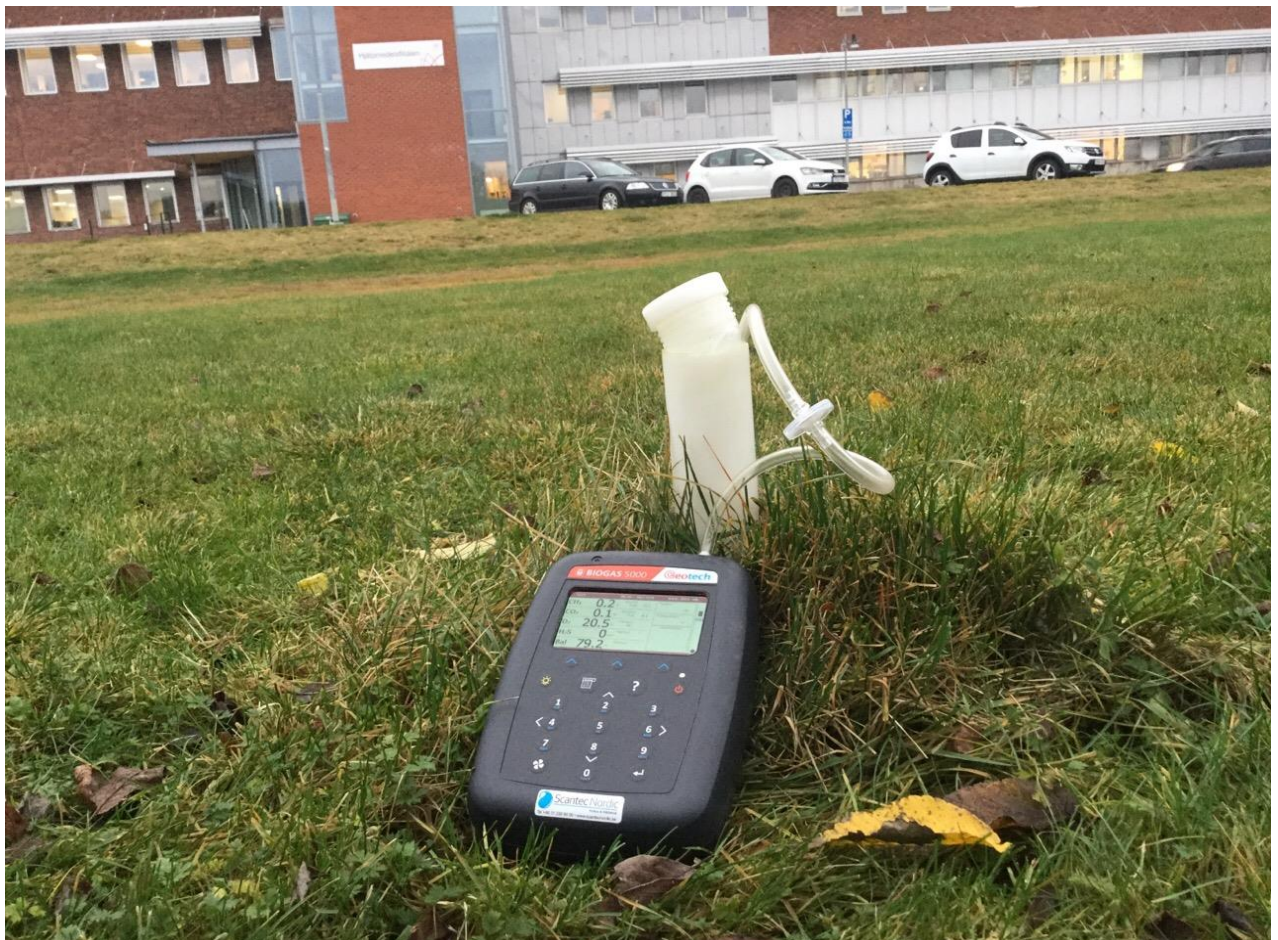
Figur 2. Mätinstrumentet för analys av metangas. Bilden är tagen vid provtagningspunkt 1.
