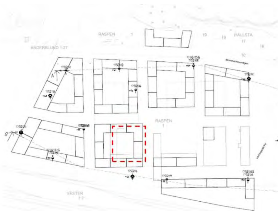
Figur 8-24: Den röda linjen markerar under vilken del av byggnaden på Raspen 1 där TRI-tvätten har stått. Planskiss med planerad bebyggelse i samma bild.
