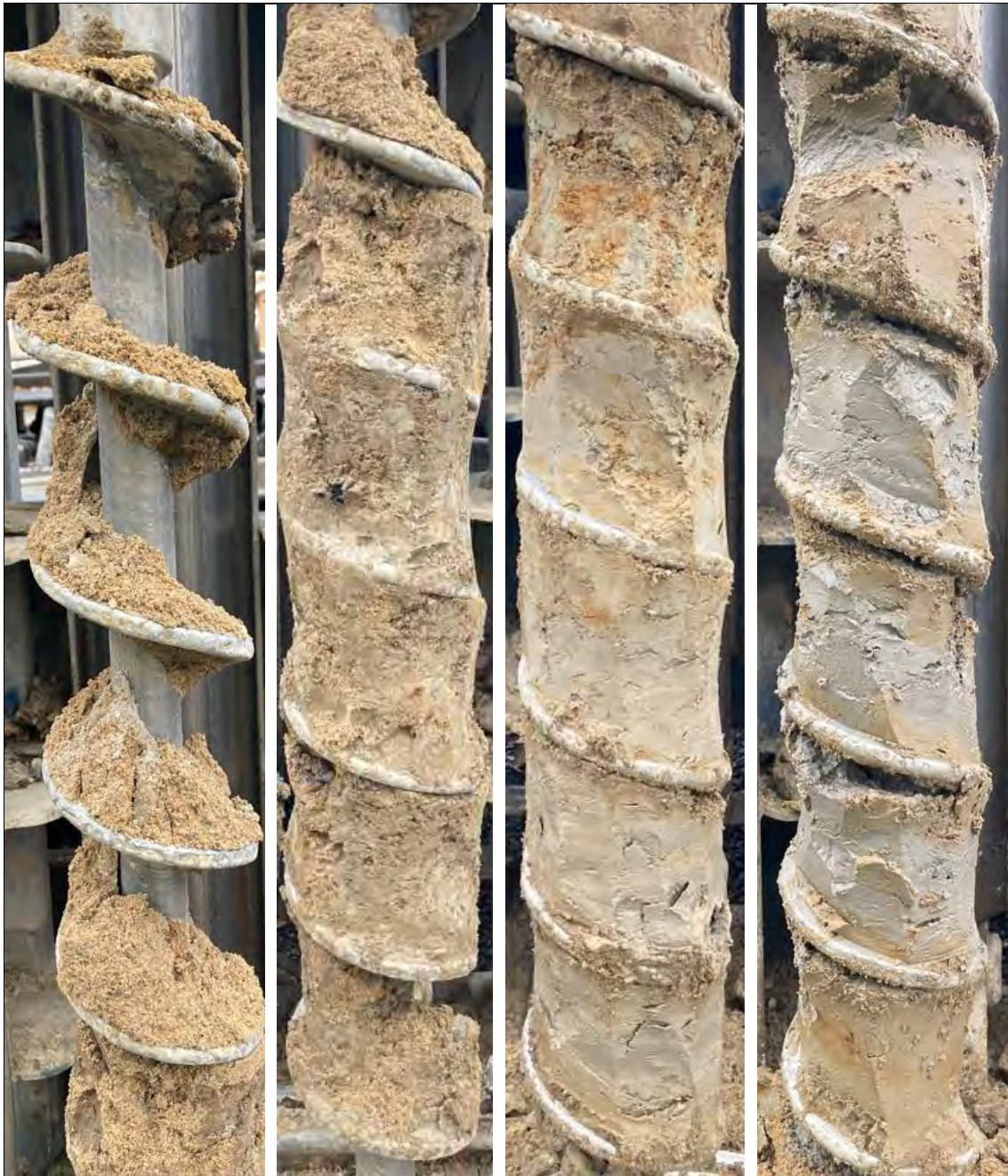
Figur 8. Markprofil i borrhål 5
