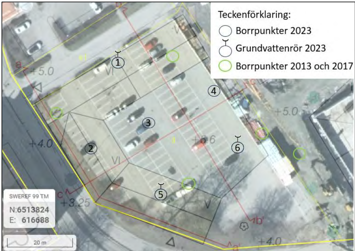
Figur 9. Provtagningskarta med borrpunkternas placering i förhållande till tidig skiss av planerade byggnader.
