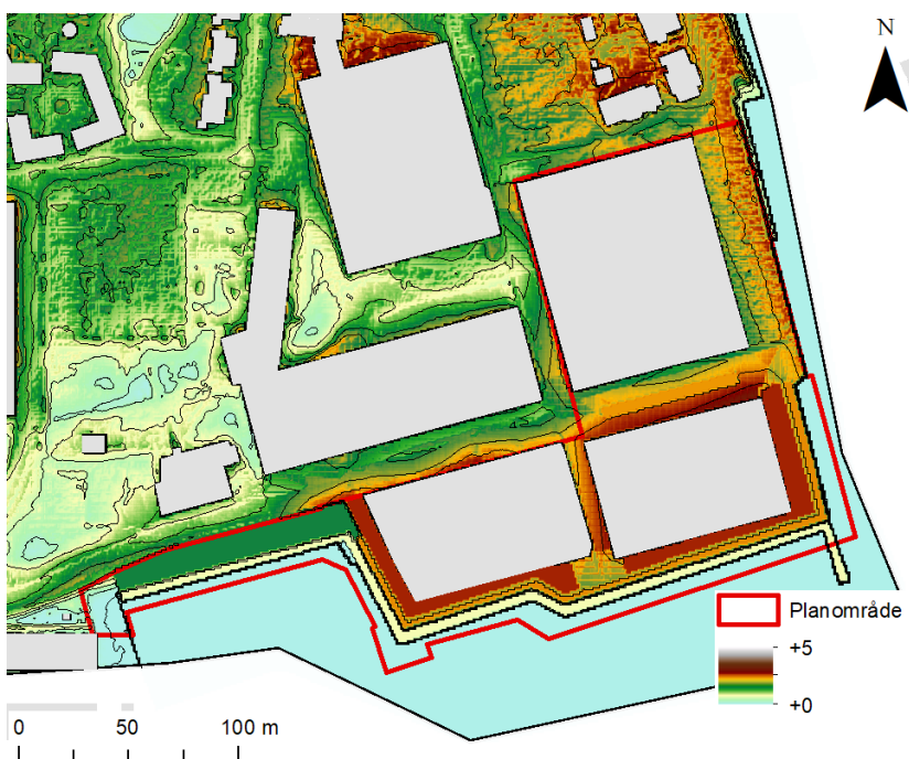
Figur 6. Höjdmodell som beskriver den framtida situationen. Områden med bruna och gröna färgnyanser ligger på en högre nivå än områden med ljusblå färgnyanser.
