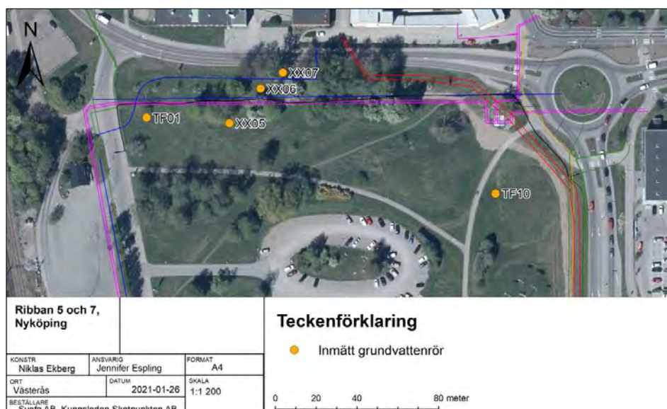
Figur 8. Grundvattenrör inom Ribban 7. Bakgrundsbild: provpunktsritning från undersökning (Terraformer, 2021).
