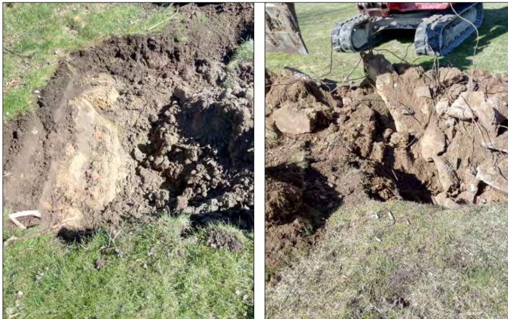
Figur 12. Exempel på jordlagerföljd inom östra delen av Ribban 7, provgroparna TF08 och TF09. Fyllningens mäktighet är 0,6 meter i TF08 och cirka 1 meter i TF09. Tegel och betong påträffades i flera provgropar på östra delen av Ribban 7. Under fyllningen finns ljus lera/silt som bedömdes kunna vara naturligt avlagrad.
