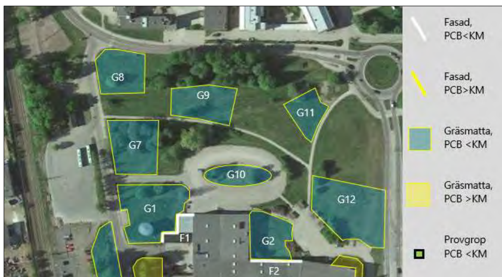
Figur 7. Del av bild från undersökningsrapport som visar var samlingsprov från ytjord tagits ut för analys av PCB (Terraformer, 2022). Proven G7-G11 är belägna inom Ribban 7. PCB påvisades inte i dessa prov.
