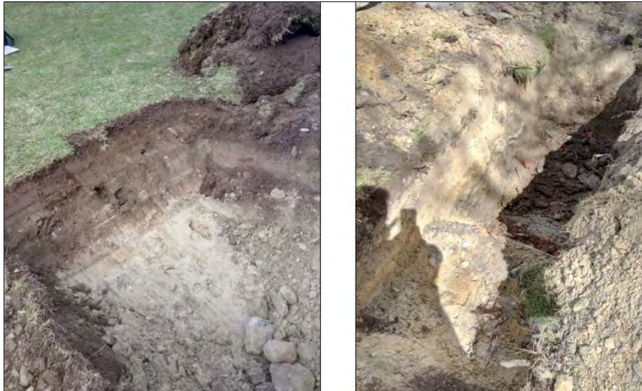
Figur 11. Exempel på jordlagerföljd inom västra delen av Ribban 7, provgroparna TF02 och TF03. Fyllningens mäktighet är 0,5 meter i TF02 och cirka 1,3 meter i TF03. Under fyllningen finns ljus lera/silt som bedöms kunna vara naturligt avlagrad.
