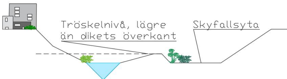
Figur 29. Exempel på princip för skyfallsyta intill damm/dike.
