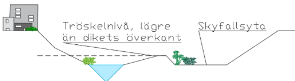
Figur 25. Principskiss över skyfallsytans utformning.
