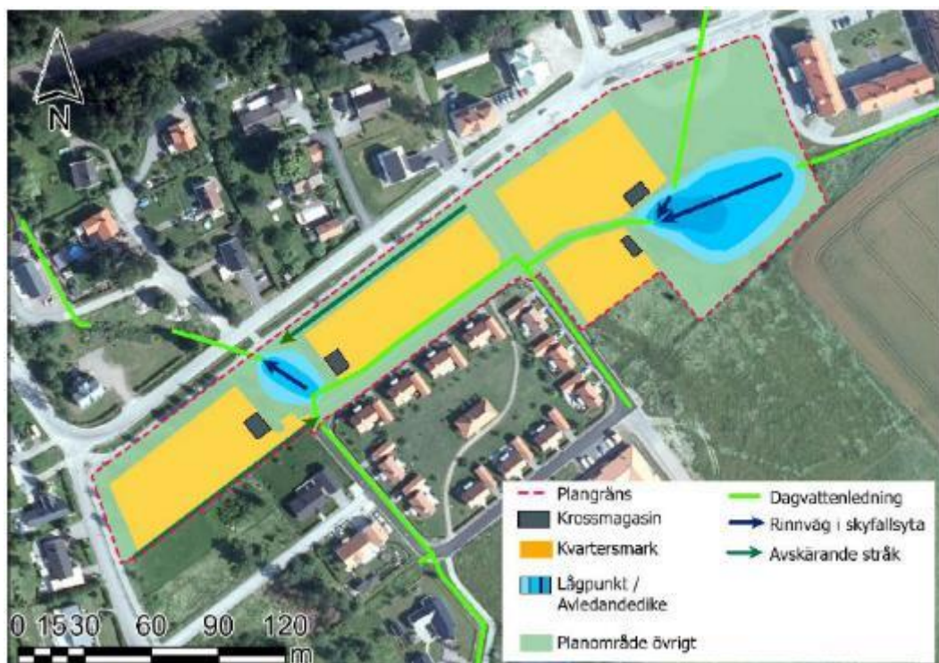
Figur 24. Föreslagen systemlösning för dagvattenhanteringen inom området.
