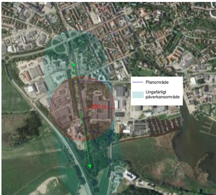
Figur B.1. Översiktbild över området för planerad bebyggelse inom Ribban 5,6 och 7. Blått markering visar ungefärligt maximalt påverkansområde för olycka på TGOJ-järnvägen, ca 300 meter. Maximalt konsekvensområde är markerat i grönt.
