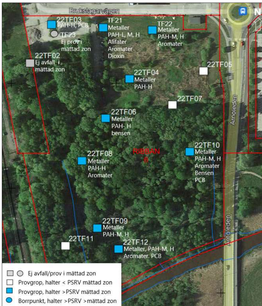
Figur 18. Provpunkter där PSRV mättad zon överskrids i fyllning och avfall under vattennivån på Ribban 6. I figuren anges även vilka ämnen eller ämnesgrupper som överskrider PSRV.
