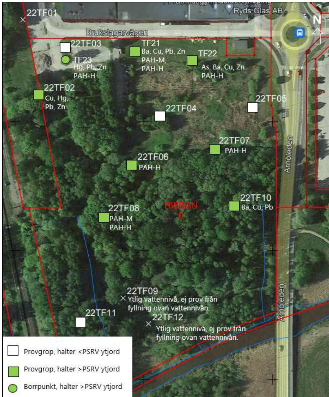
Figur 17. Provpunkter där PSRV ytjord (0-1 m) överskrids i fyllning ovan vattennivån på Ribban 6. I figuren anges även vilka ämnen som överskrider PSRV.
