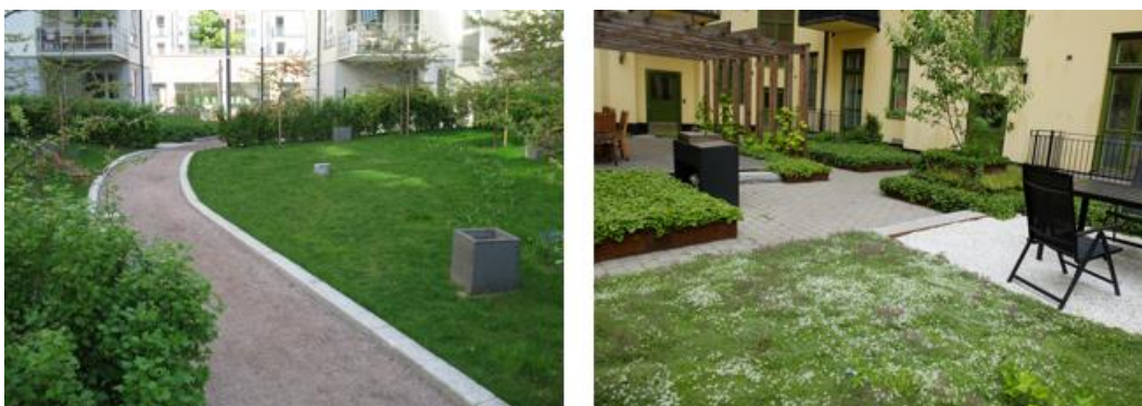
Figur 18. Utformning av gröna gårdar med upphöjda växtbäddar på bjälklag. Foto: Ulrica Carlberg, Vegtech).
