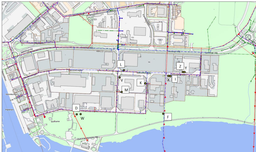
Figur 6. Provplacering vid gasmätning 3. De inramade bokstäverna symboliserar punkter där mätning utfördes på markytan. De bokstäver som saknar ram redovisar var provtagning gjordes över borrarat hål i marken.
