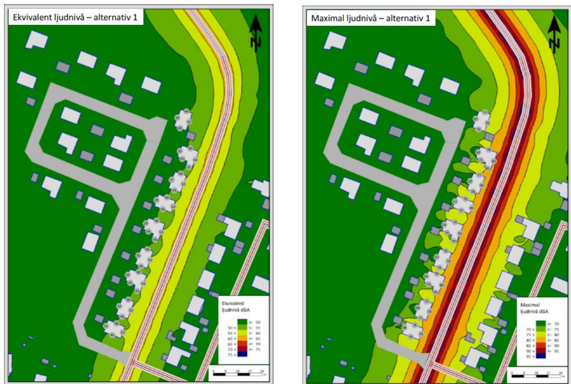
Bilder över ekvivalent och maximal ljudnivå med alternativ 1 (villor längs med Runstensvägen)
