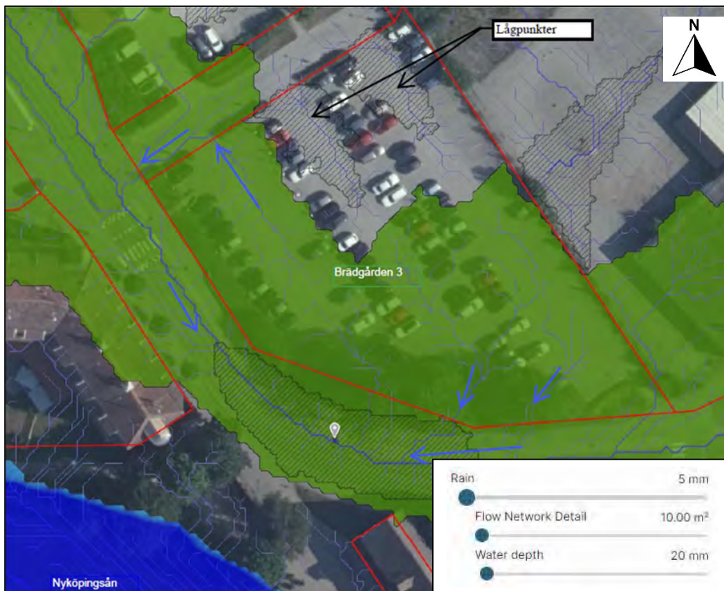
Figur 2. Rinnvägar och lågpunkter för dagvatten i befintlig situation vid 5 mm nederbörd. Avrinning från området är markerad med blåa pilar. Blåa yta i väster visar +2m nivån på Nyköpingsån, gröna området är avrinningsområdet. (scalgo.com/live)
