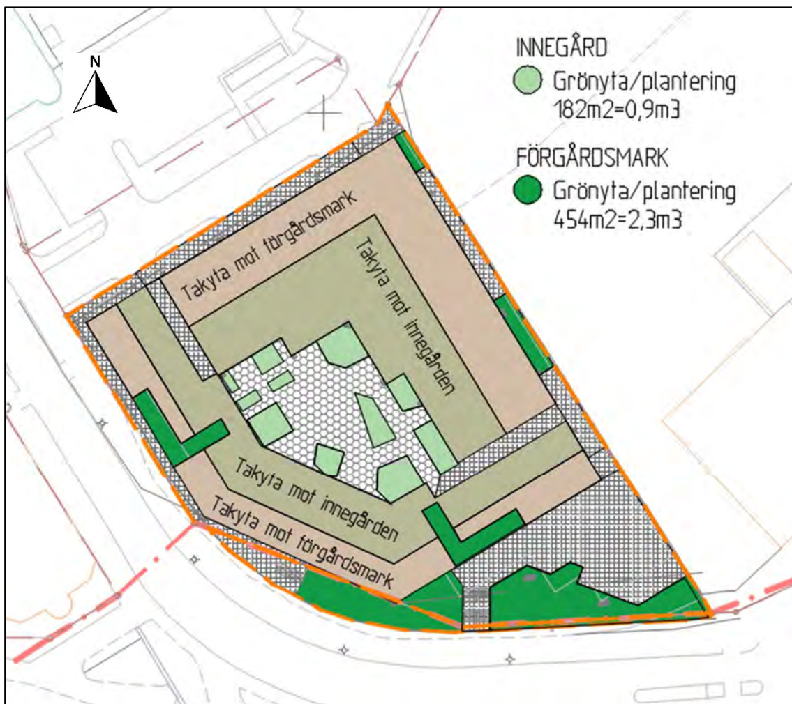
Figur 6. Systemlösning för dagvattenhantering för Brädgården 3. En del av takytan på den sydvästra byggnaden kommer att utformas som en takträdgård.
