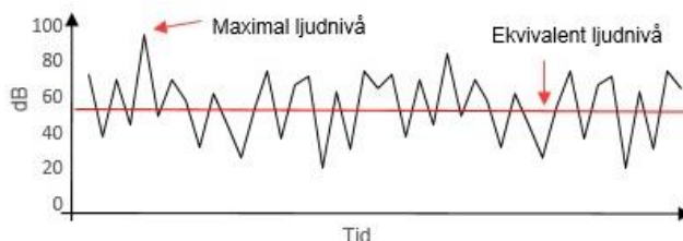
Figur 4. Illustration av ekvivalent och maximal ljudnivå under en bestämd tidsperiod.
