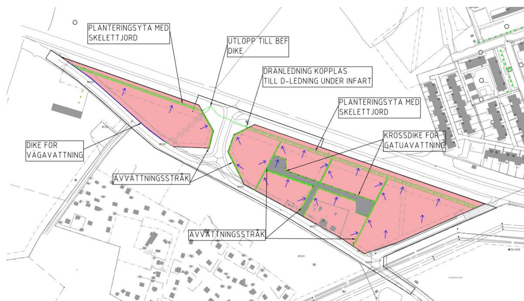
Figur 7) Principlösning för dagvattenhantering inom planområdet. Figuren finns även i Bilaga 1.
