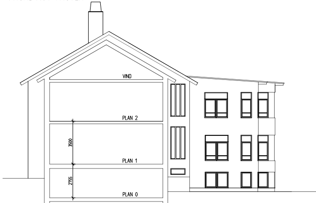
SEKTION GENOM BEFINTLIG BYGGNAD, DELFASAD MOT ÖSTER
