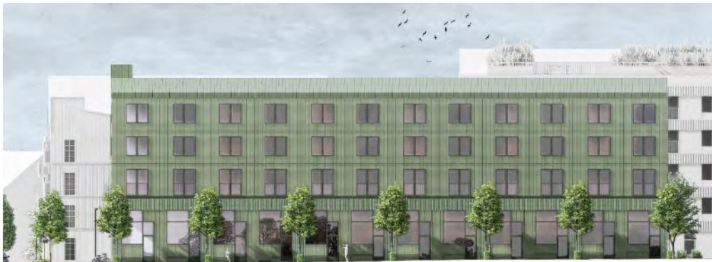
Figur 9: Fasad mot Industrigatan. Förhöjd sockelvåning som livar med Sunlightfabrikens sockelvåning på motstående sida gatan (Arkitema, 2020).
