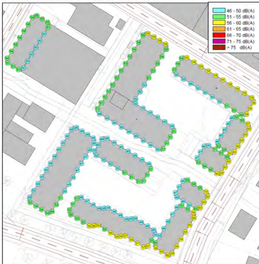
Figur 18. Ekvivalent ljudnivå från väg- och spårtrafik vid fasad, högsta nivå oavsett våningsplan. Prognos 2040 (Magenta Akustik 2021).
