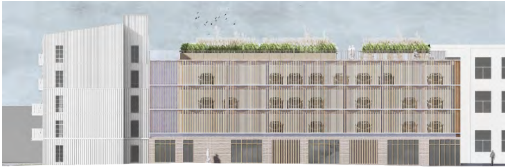
Figur 11: Fasad mot kvartersgatan. Mobilitetshusets fasad med uppglasad sockelväning och genomsiktig träfasad (Arkitema, 2020).
