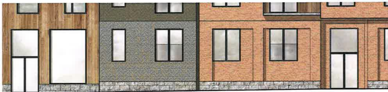
Sockel till fasad mot Ringvägen, variation i material, kulör, funktion och entrérum. Markering i tegel för eventuellt butiksläge.
