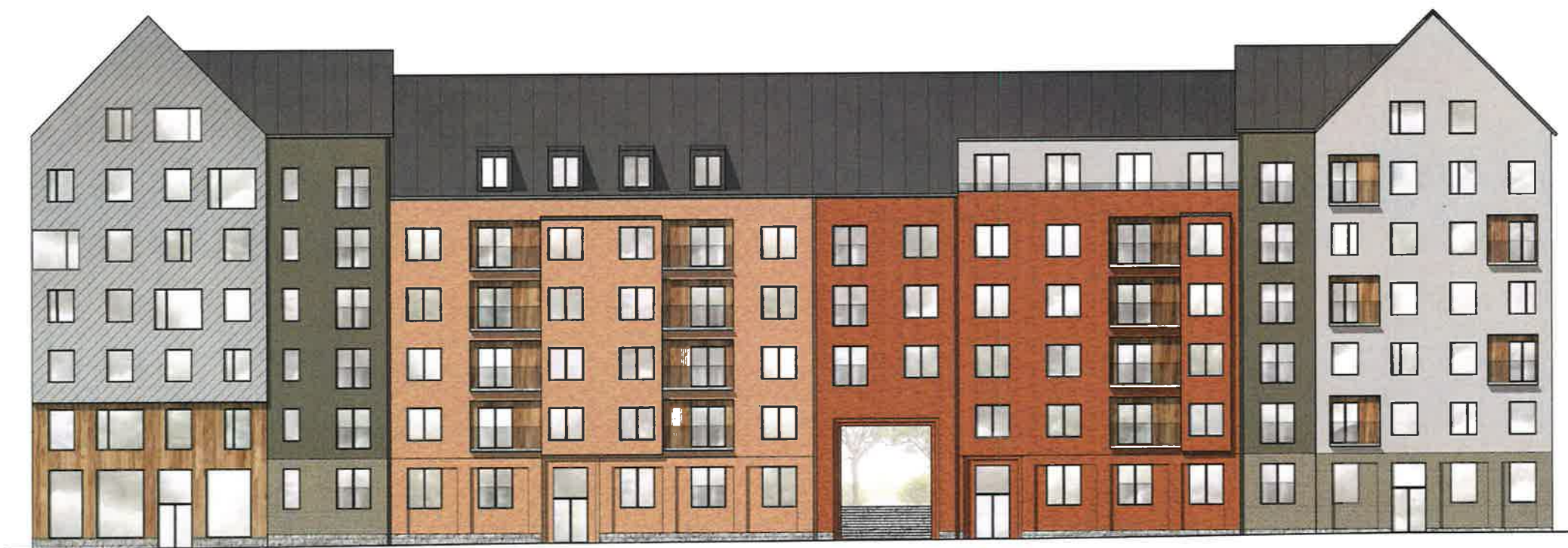
Fasad mot Ringvägen, Kvarter 3. Vertikala fönsteraxlar, gavelmotiv och portik.
