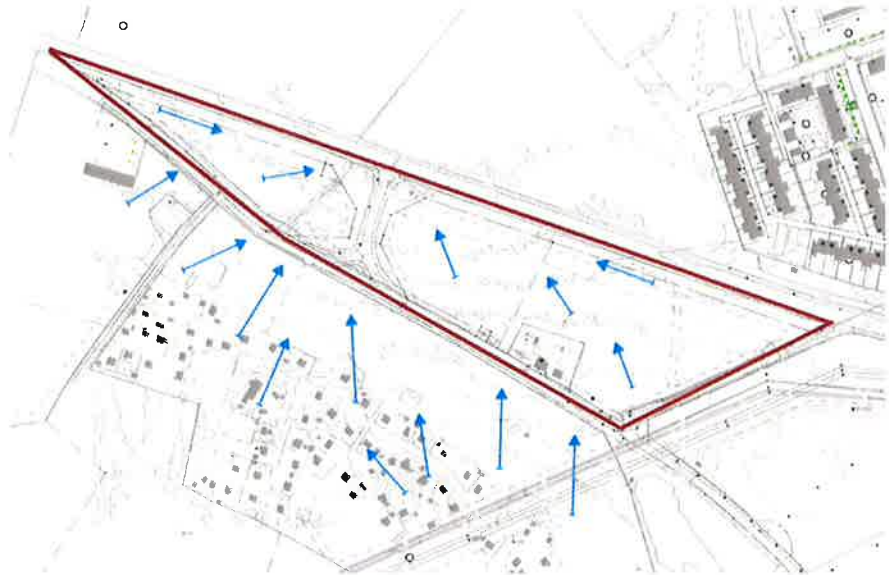
Figur 5) Naturliga avrinnings- och flödesvägar utifrån befintlig topografi.
