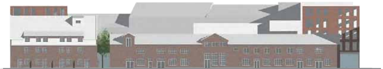
Elevation söderfasad. Slakteriet förbereds för ett publikt innehåll. Igensatta muröppningar för fönster återställs och nya entrépartier skapas i befintliga fönsterlägen med nya muröppningar ned till golvnivå.
