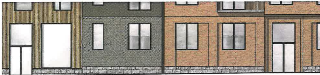
Sockel på fasad mot Ringvägen, variation i material, kulör, funktion och entrérum. Markering i tegel för eventuellt senare butiksläge och skyltfönster.
