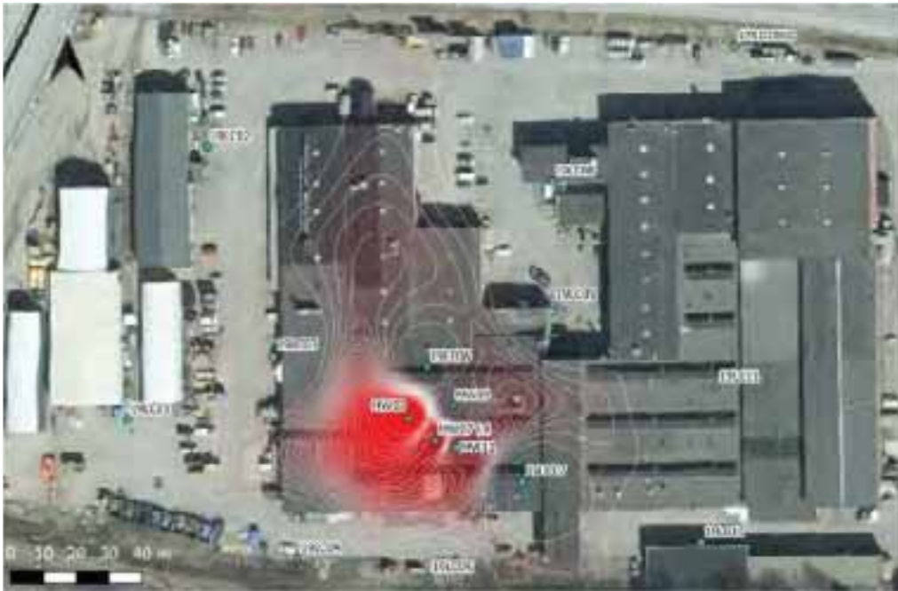
Figur 8-26: Interpolering av halter klorerade alifater i grundvatten på ca 12–14 m djup, baserat på prover tagna i grundvattenundersökningarna under 2019. Modell skapad i QGIS. Alla halter i \mu\text{g/l} . Interpoleringen bör endast ses som en fingervisning av föroreningsutbredning och inte som skarpa gränser. Högsta halter i rött, därefter avtagande mot färglöst, linjeavstånd ca 800 \mu\text{g/l} .
