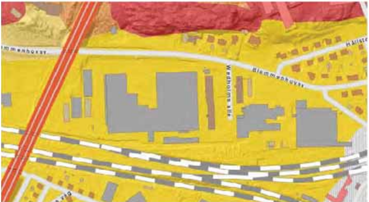
Figur 8-22: Översiktlig kartering av jordarter enligt SGU:s kartvisare, hämtad 2017-08-08. Gult=lera, rött=berg, orange med vita prickar=svallsediment grus, randigt=fyllning
