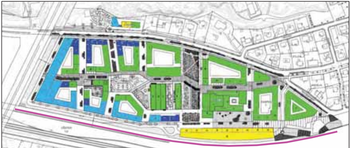
Figur 5. Möjligheter för Huvudalternativet att bygga lägenheter, förutsatt en 5 m hög skärm längs järnvägen (markerad i rosa). Grönt: lägenheter möjliga utan hänsyn till trafikbuller. Mörkblå: ljuddämpad sida som uppfyller riktvärdena finns. Ljusblå: riktvärdena för ljuddämpad sida kan klaras med hjälp av lokala åtgärder. Gult: åtgärder behöver utredas ytterligare om bostäder större än 35 m 2 skall byggas i hela huskroppen.
