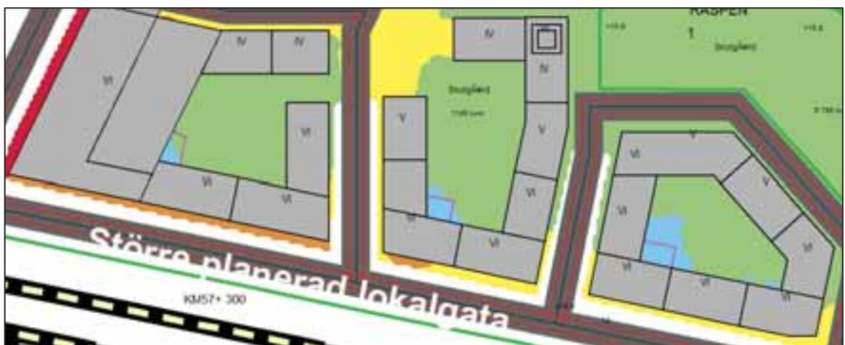
Figur 7. Exempel på lokal skärmåtgärd som åstadkommer resp. utökar områden på innergårdarna i kvarter 1-3 med ljudnivåer motsvarande riktvärdena för uteplats, i form av skärmtak (markerad i rosa). Skärmtaken har placerats 3 m över mark och har ljudabsorberande undersida. Blå områden visar ljudnivåer motsvarande riktvärdena för trafikbuller vid uteplats.
