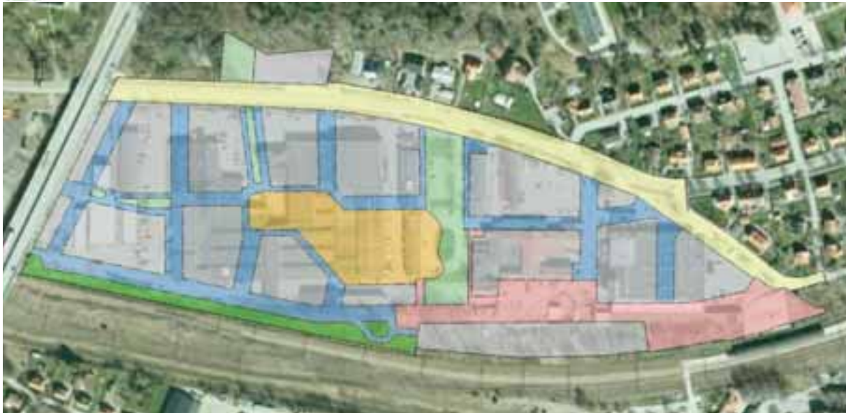
Figur 8. Områdesindelning i kvartersmark och kommunal mark för planområdet. Kommunal mark innefattar kommunal gata, lokalgator samt allmän platsmark. Indelning av kvartersmark och allmän platsmark baseras på utkast på plankarta daterad 2019-02-22. Skillnaderna jämfört med aktuell plankarta bedöms vara marginella och påverkar inte beräkningarna på ett betydande sätt.
