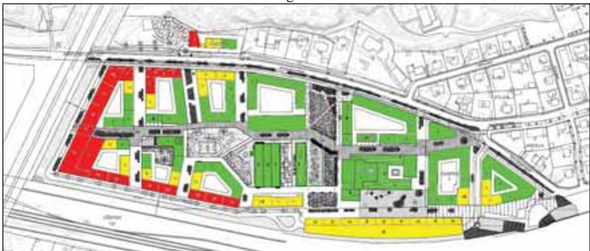
Figur 3. Möjligheter för Huvudalternativet att bygga lägenheter utan hänsyn till trafikbuller. Grönt: lägenheter möjliga i hela husdelen. Gult: lägenheter om som mest 35 m 2 möjliga i hela husdelen. Rött: lägenheter ej möjliga i hela husdelen utan hänsyn till trafikbuller.
