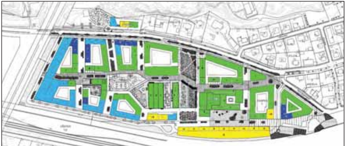
Figur 4. Möjligheter för Huvudalternativet att bygga lägenheter med hänsyn till trafikbuller, genom att ge minst hälften av bostadsrummen tillgång till ljuddämpad sida. Mörkblå: ljuddämpad sida som uppfyller riktvärdena finns. Ljusblå: riktvärdena för ljuddämpad sida kan klaras med hjälp av lokala fasadåtgärder. Rött och gult: lokal åtgärd otillräcklig (se "6.5 Åtgärdsförslag").
