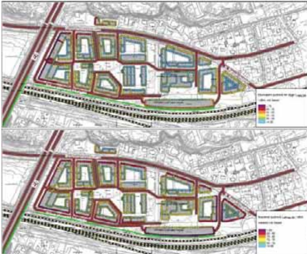
Dygnskvivalent resp. maximal ljudnivå, från väg- och spårtrafik. Utdrag ur bullerutredning, Structor 2020-05-15.
