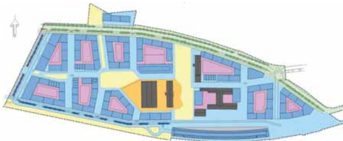
Figur 13. Åtgärdsförslag för dagvattenhantering inom hela planområdet. Framtagande av åtgärdsförslag baseras på utkast på plankarta daterad 2019-02-22 och strukturplan daterad 2017-05-09. Skillnaderna jämfört med aktuell plankarta och strukturplan bedöms vara marginella och påverkar inte beräkningarna på ett betydande sätt.
