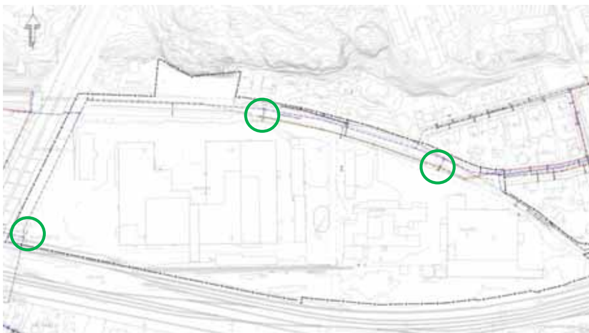
Figur 4. Befintligt kommunalt VA-nät i anslutning till aktuellt planområde. Gröna markeringar visar befintliga anslutningspunkter.
