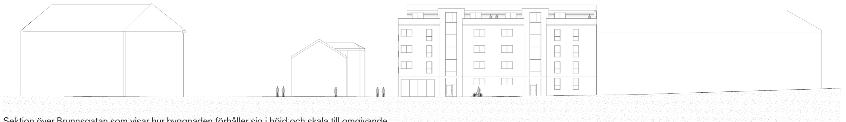
Sektion över Brunnsgatan som visar hur byggnaden förhåller sig i höjd och skala till omgivande bebyggelse.
