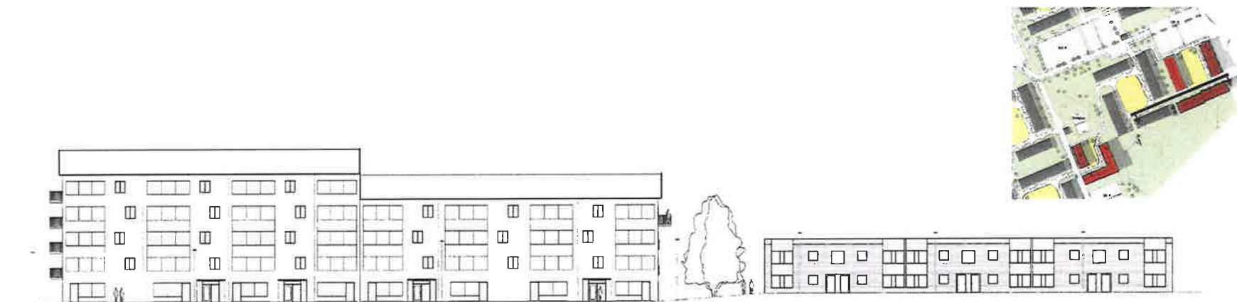
Sektion över den östra nya gården i höjd med fastigheten Hästen 2 Bilden visar höjdförhållandena mellan det befintliga och nya huset.
