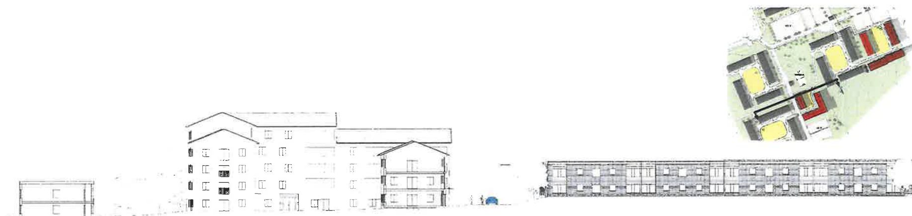
Sektion över den västra nya gården i höjd med fastigheten Hästen 2 Bilden visar höjdförhållandena mellan det befintliga och nya huset.
