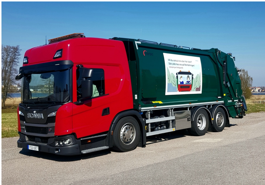
Figur 4 Tvåfackad treaxlad baklastare för insamling av matavfall och restavfall i Nyköping. Foto: Nyköpings kommun
