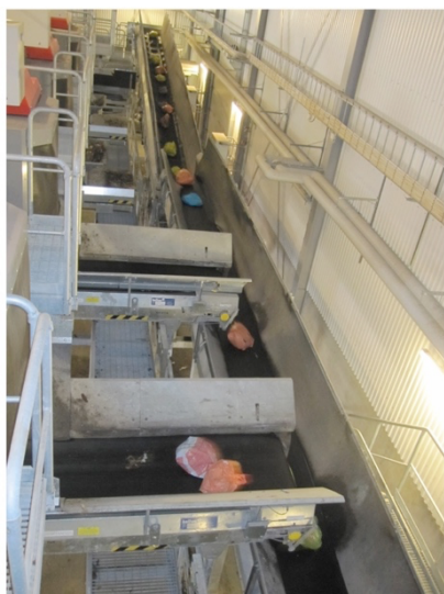
Figur 13 Transportband med olikfärgade påsar som sorteras efter färg med hjälp av optisk avläsning. Exempel från Eskilstuna. Foto: Optibag AB
