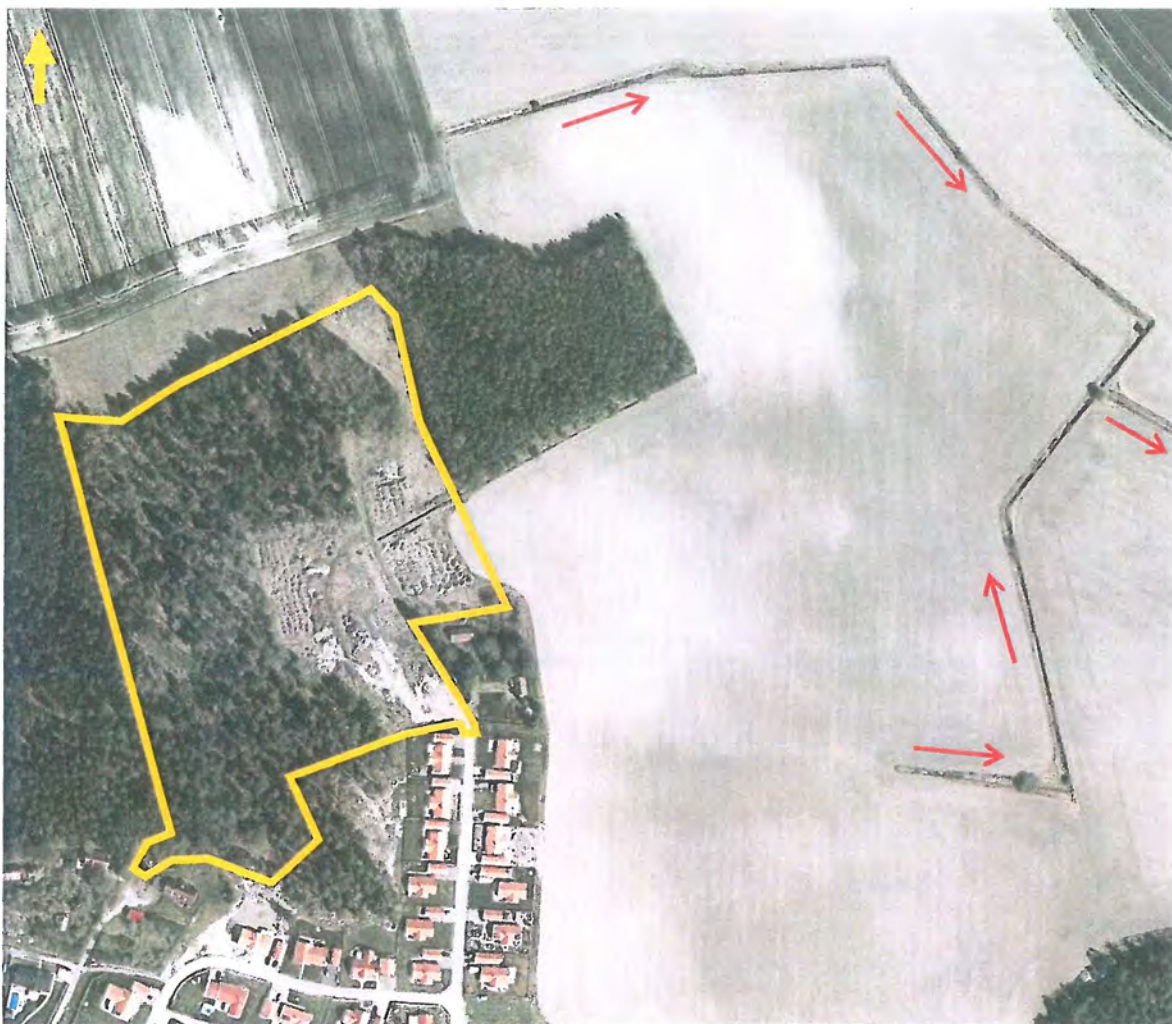
Figur 2. Flygfoto över planområdet och dess närmaste omgivning. Planområdets ungefärliga gräns är markerad med orange polygon. Röda pilar visar flödesriktningen i befintligt dikessystem nedströms planområdet.
