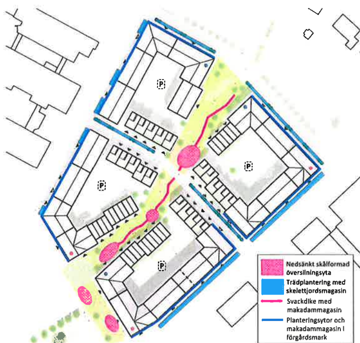
Figur 18. Åtgärdsförslag för dagvattenhantering (Structor/underlag Urban Minds).
