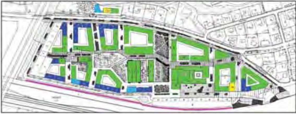
Figur 8-16: Möjligheter för huvudalternativet att bygga lägenheter, förutsatt en 5 m hög skärm längs järnvägen (övre bilden). Grönt: Lägenheter möjliga utan hänsyn till trafikbuller. Mörkblå: ljuddämpad sida som uppfyller riktvärdena finns. Ljusblå: riktvärdena för ljuddämpad sida kan klaras med hjälp av lokala åtgärder. Gult: åtgärder behöver utredas ytterligare om bostäder större än 35 m 2 skall byggas.
