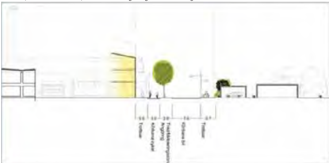
Sektion (AA, markerad ovan) över Norra Bangårdsgatans - Framtida situation där industriområdet har ersatts med ny stadsbebyggelse och gaturummet har kompletterats med bredare trottoarer, gatuträd och cykelbana. Föreslagen ny stadsbebyggelse illustrerad i gult.
