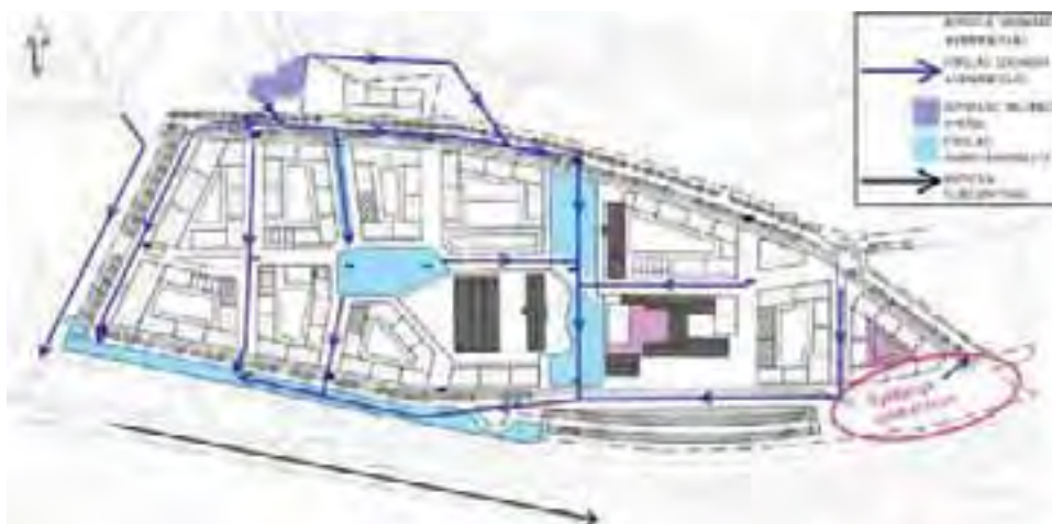
Förslag till sekundära avrinningsvägar inom planområdet för ytavrinning i samband med extrema regn. Utsnitt ur dagvattenutredning (Structor 2020-05-14)
