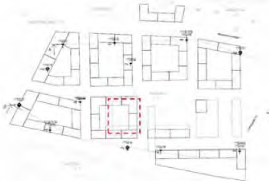
Figur 8-24: Den röda linjen markerar under vilken del av byggnaden på Raspen 1 där TRI-tvätten har stått. Planskiss med planerad bebyggelse i samma bild.
