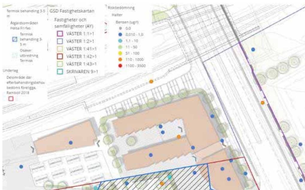
Förhöjda halter av bensen och PFAS förekommer i grundvattnet på fastighet Väster 1:2.
