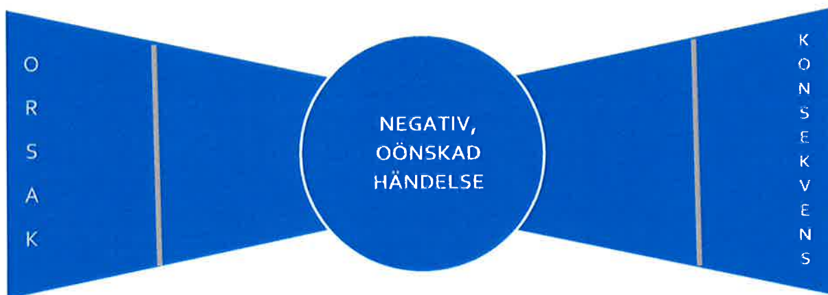
Figur 4 Bow tie-modellen kan användas för att identifiera och beskriva risker. I cirkeln placeras en negativ, oönskad händelse som kan inträffa i kommunen. Denna kan sedan delas upp i orsaker och konsekvenser. De gråa strecken illustrerar barriärer eller åtgärder. Barriärer på den vänstra sidan är proaktiva, och syftar till att förhindra att den negativa händelsen inträffar. Barriärer på den högra sidan är reaktiva och syftar till att reducera konsekvenserna av händelsen om den har inträffat.
